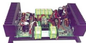
Alimentatore Doppio Canale Con due uscite per canale da 10A
