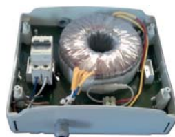
Toroidale con magnetotermico resinato in cassetta plastica
