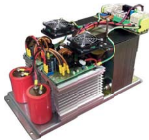
Alimentatore custom con trasformatore
